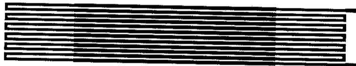
Figure 31 : Enroulement chauffant type circuit imprimé
