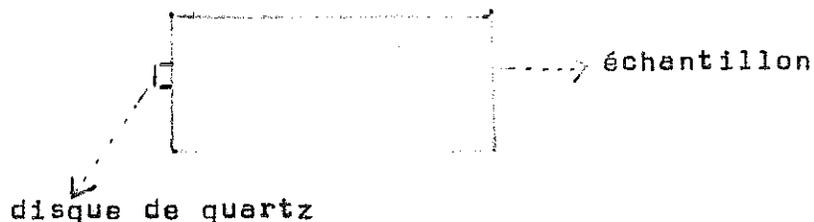
Ce quartz, dont la direction de coupe définit le type d'onde générées (longitudinales, transverses ou non pures), peut entrer en vibration (effet piézo-électrique) par application d'une tension électrique à une fréquence égale ou multiple impaire de la fréquence de résonance du quartz.
