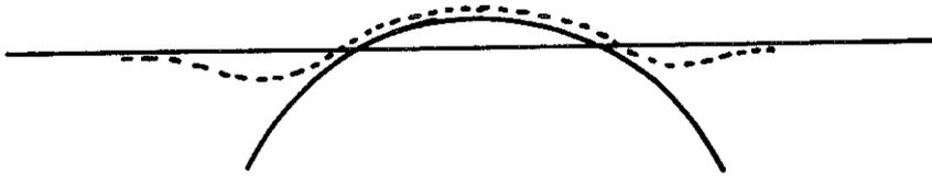
Déformation plastique au cours d'un essai de dureté Figure 9
